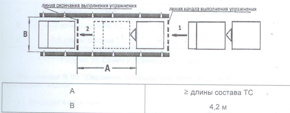
Рисунок 15. Схема и размеры элемента упражнения N 9 - "Расцепление прицепа с тягачом"
